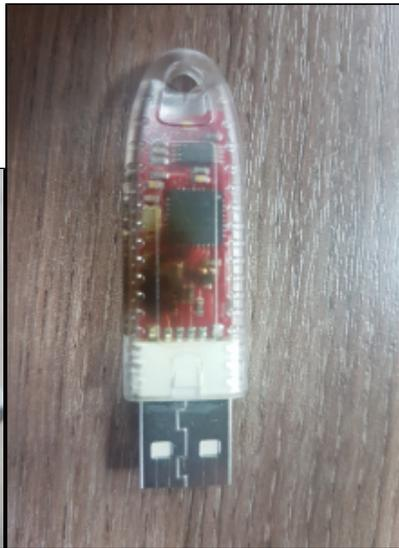
Рутокен со следами оплавления и/или почернения можно направить на дополнительную экспертизу. Если в ходе экспертизы будет выявлено **умышленное повреждение** или **превышение допустимого напряжения, подаваемого в USB-порт**, гарантийная замена Рутокена на новый произведена не будет.
